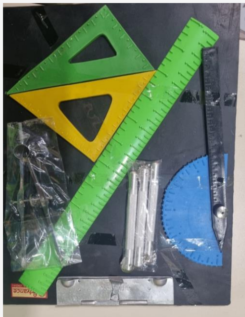
Fotografía C2. Set de dibujo propiedad de la Escuela, en la que se aprecia juego de escuadras, regla, transportador, compás y tabla en relieve, propio para personas con discapacidad visual.
