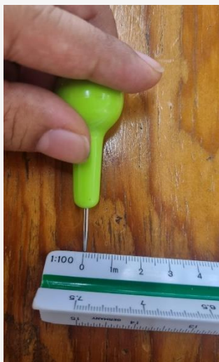
Fotografía 10. Punzón propiedad del estudiante, Funciona como lápiz al hacer los trazos de las dimensiones de las vistas en las láminas perforadas
