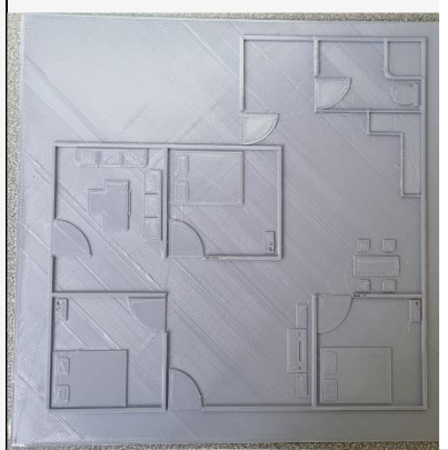
Fotografía 10. Plano arquitectónico en relieve elaborado por CITE, con la finalidad de dar a conocer cómo se representan los diferentes elementos en los planos. Esto como aporte adicional de conocimiento.
